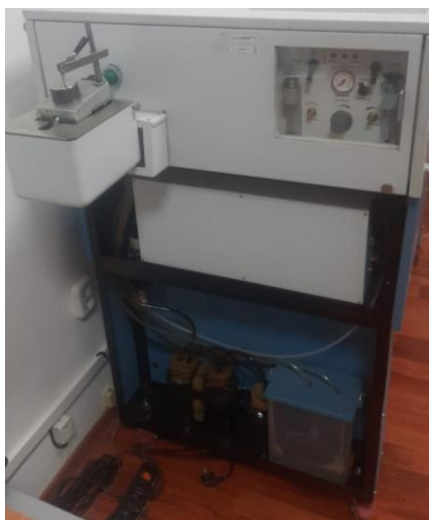
Сурет 2.3 –ДФС-71 вакуумды көп арналы эмиссиялық спектрометрі
