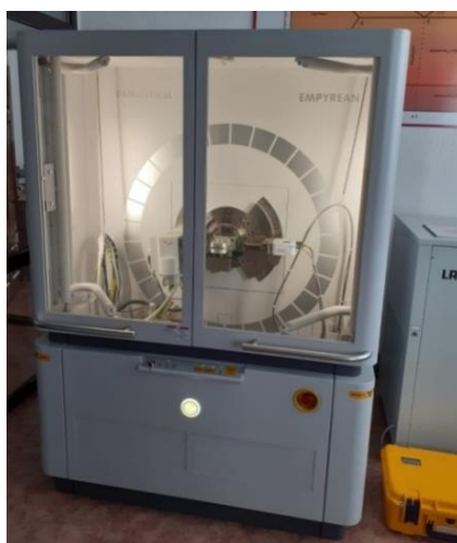
Сурет 2.1 –Panalytical фирмасының 2 сериялы Empyrean рентгендік дифрактометрі
