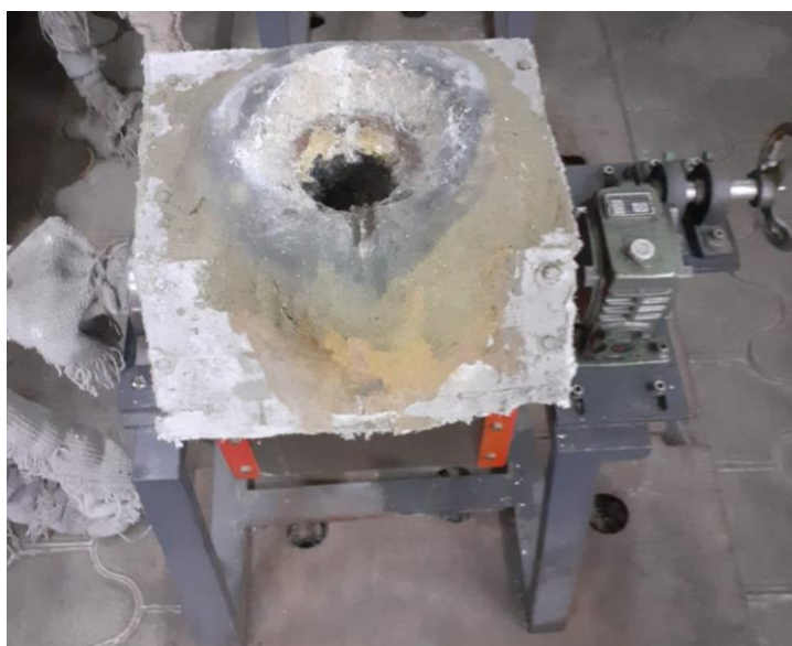
Сурет 2.14 –Кенді көмірлі шекемтастарды балқытуға арналған GW-MF -25 индукциялық пеші
