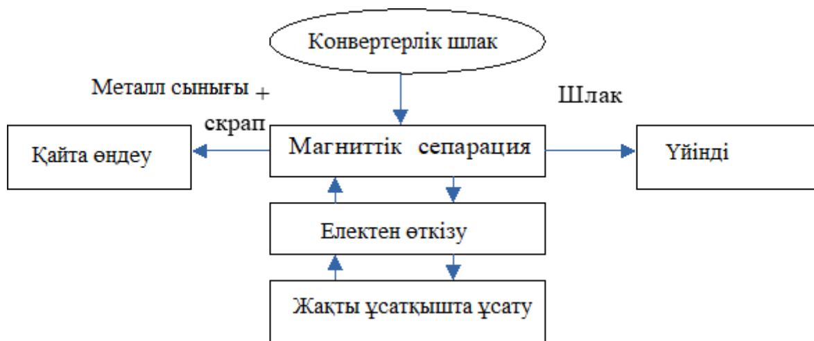
Сурет 4.1 – «АрселорМиттал Теміртау АҚ конвертерлік шлақты өңдеудің қолданыстағы схемасы [71]
