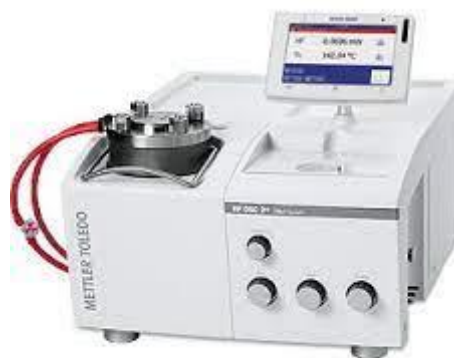
Сурет 2.6 – TGA/DSC2 дифференциалдық сканерлеуші калориметрі
