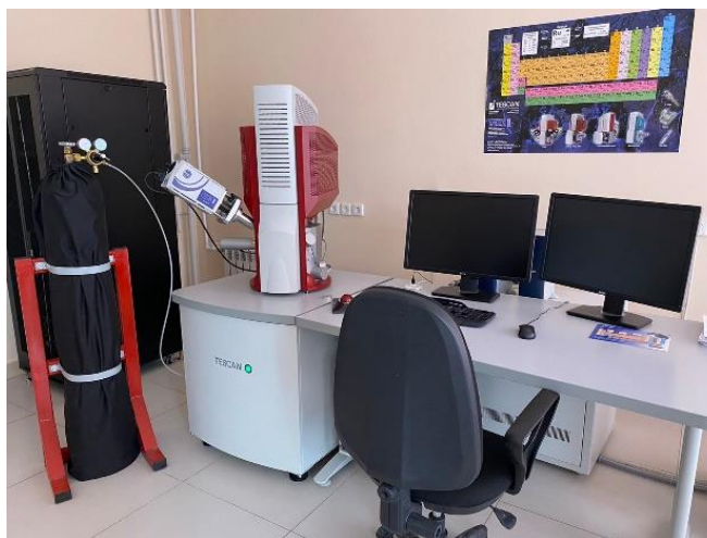
Сурет 2.2 –TESCAN Mira 3 сканерлеуші электронды микроскобы
