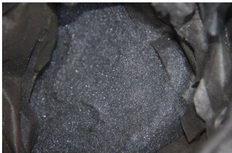
Рисунок 23 – Высокочистый кремний квалификации SoG-Si марки 6-7N
