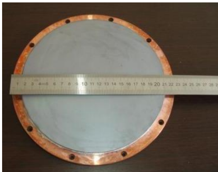
Рисунок 25 - Мишень из кремниевого кристалла, подготовленная для магнетронного напыления и установленная на медном токоподводящем фланце
