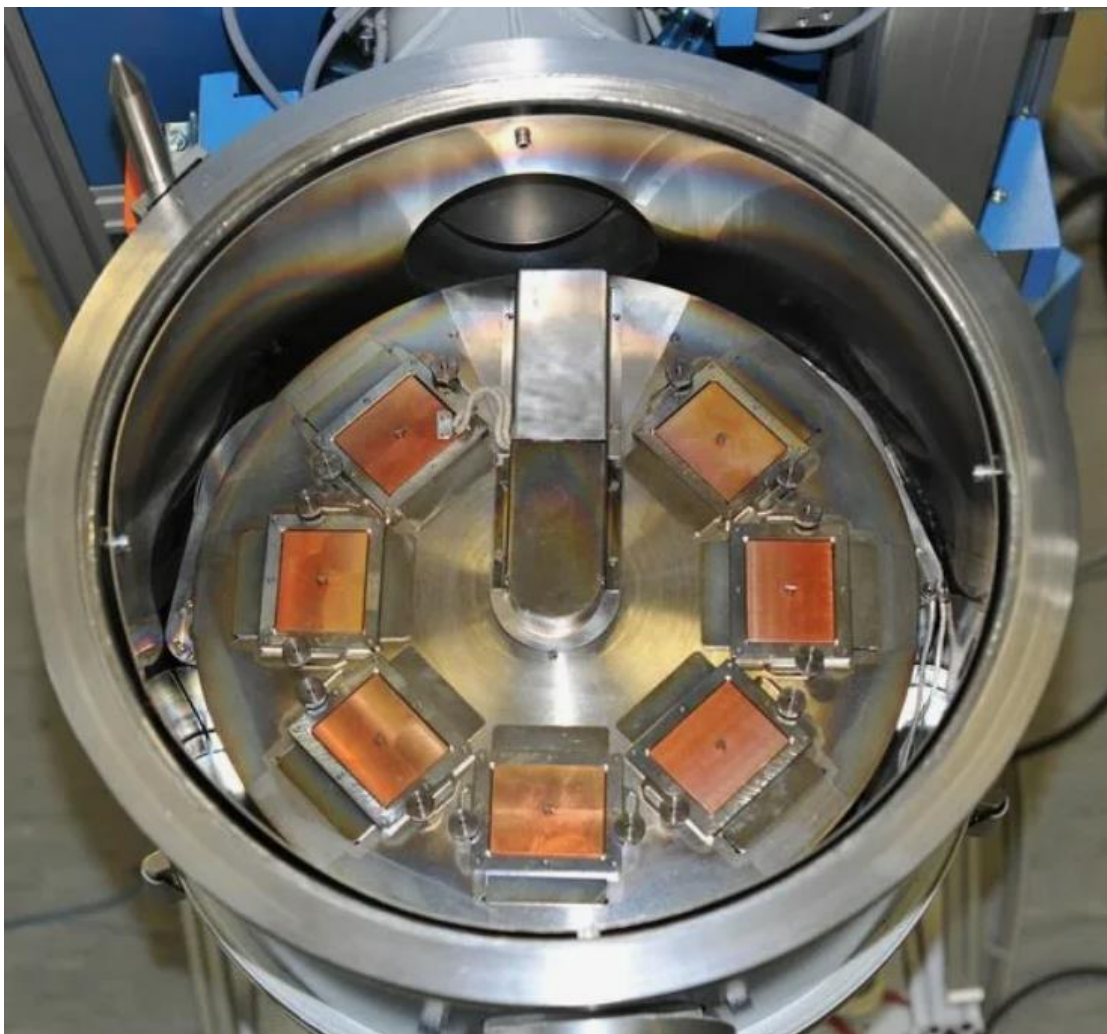
Рисунок 27 – Рабочая камера с подготовленными медными подложками
