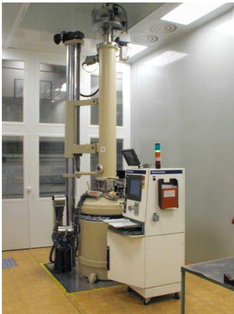
Рисунок 22 - Оборудование марки TCR-5C-1к/т, производитель Techno Search Corporation (Япония) для выращивания кристаллов по методу Чохральского
