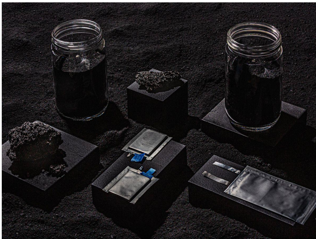
Рисунок 5 - Наноструктурированный кремниевый материал, который выглядит так же, как графитовый порошок, используемый для изготовления анодов в современных литий-ионных батареях, но обещает поставлять батареи с большим запасом хода и быстрой зарядкой [36]
