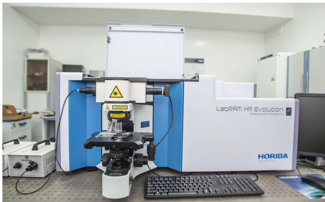
Рисунок 24 – Рамановский спектроскопический анализатор марки Horiba Jobin–Yvon HR800UV (Франция)
