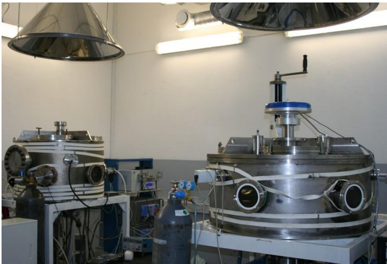
Рисунок 1 – Пример технологического оборудования магнетронного напыления (PDV) [13]
