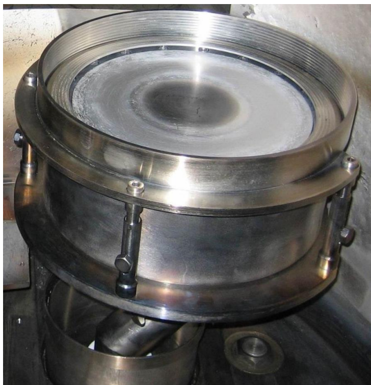
Рисунок 26 – Мишень, смонтированная в корпусе магнетрона
