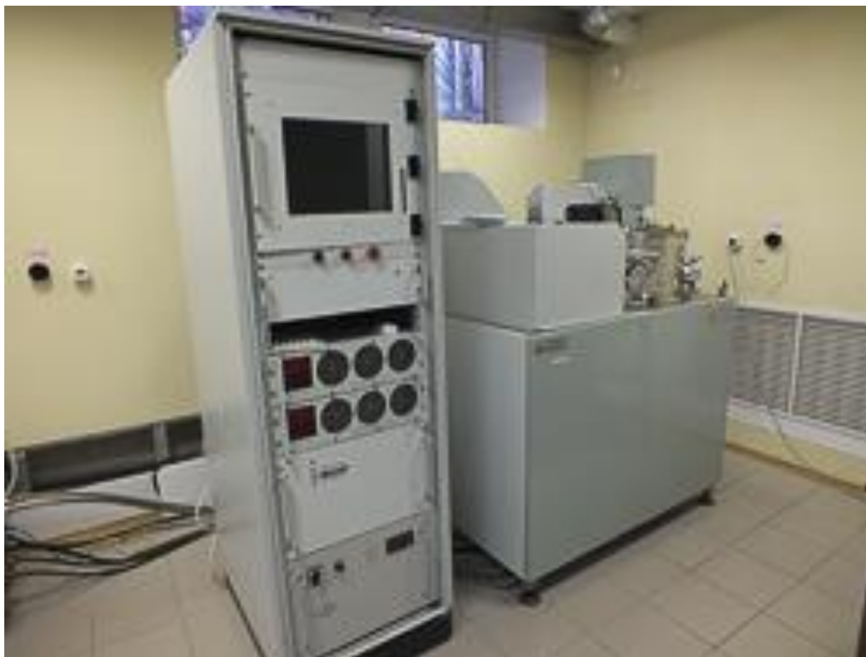
Рисунок 18 - Оборудование системы магнетронного напыления Caroline D12C подготовленное к работе
