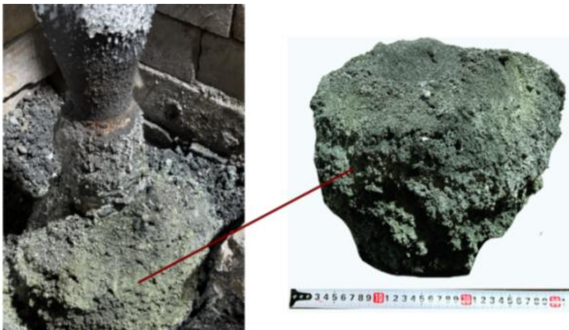
Сурет 4.26 – Күріш қауызы және мұнай коксы құрамындағы \text{SiO}_2 / \text{C} = 1,5 арақатынасы кезіндегі синтезделген материал
