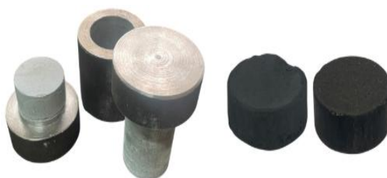
Сурет 4.7 – Механикалық өңделген материалдардан дайындалған брикеттер
