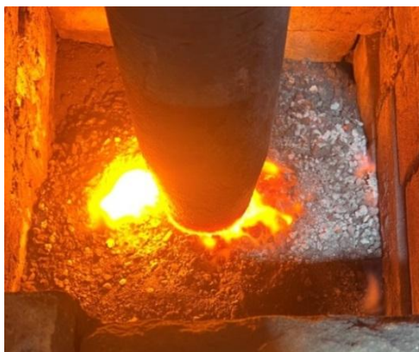
Сурет 4.24 – SiC синтездеу үрдісінің пеш мойындығындағы бейнесі
