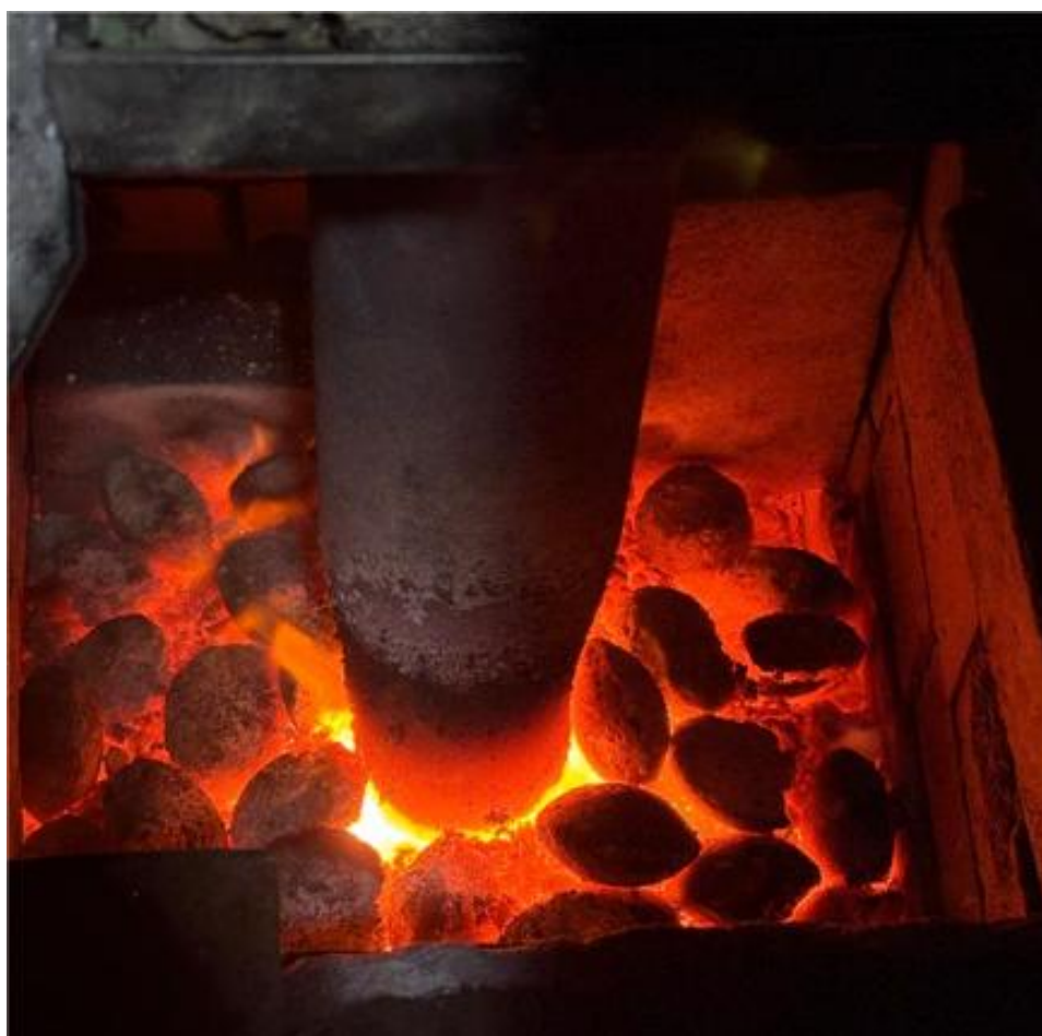
Сурет 4.12 – SiC синтездеу үрдісінің пеш мойындығындағы бейнесі
