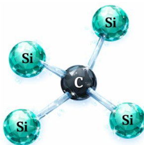
Сурет 1.1 – SiC бөлшектерінің ковалентті байланысы
