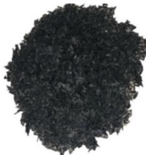
Сурет 3.23 – Күріш қауызын 800^\circ\text{C} пиролиздеуден алынған кремнийлікөміртегілі өнім
