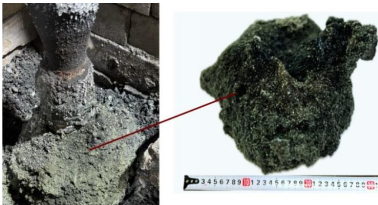
Сурет 4.27 – Күріш қауызы және мұнай коксы құрамындағы \text{SiO}_2/\text{C} = 2 арақатынасы кезіндегі синтезделген материал
