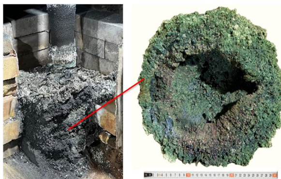
Сурет 4.16 – Микрокремнезем және мұнай коксы құрамындағы \text{SiO}_2/\text{C} = 1,5 арақатынасы кезіндегі синтезделген материал
