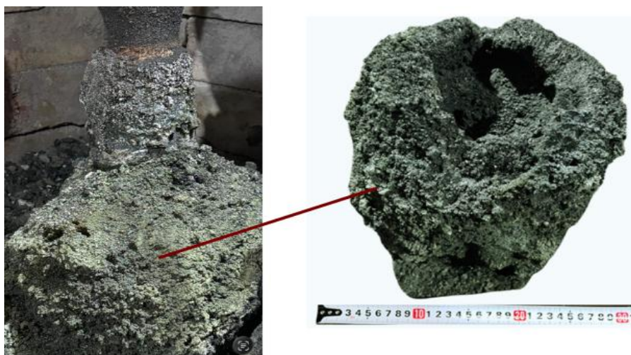
Сурет 4.25 – Күріш қауызы және мұнай коксы құрамындағы \text{SiO}_2/\text{C} = 1 арақатынасы кезіндегі синтезделген материал
