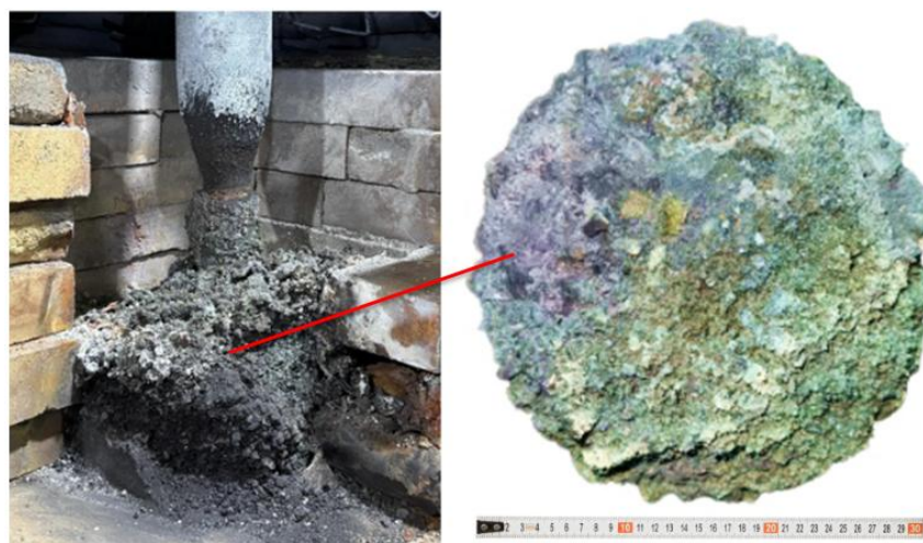
Сурет 4.17 – Микрокремнезем және мұнай коксы құрамындағы \text{SiO}_2/\text{C} = 2 арақатынасы кезіндегі синтезделген материал
