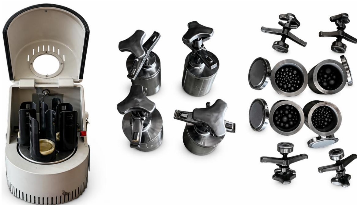
Сурет 3.24 – ПЦД-нің, ұнтақтау стаканының және ұнтақтаушы шарларының бейнесі
