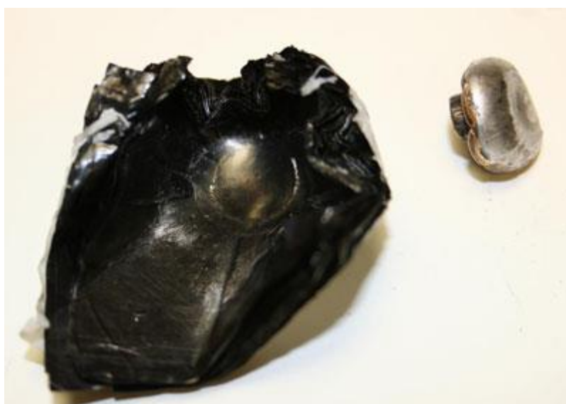
Ткань CNT остановила снаряд калибра 9 мм в оболочке в контролируемых баллистических испытаниях. Показанный материал имеет примерно такую же толщину, как шесть сложенных стопкой визитных карточек. (Источник: Нанокомп Технологии)
